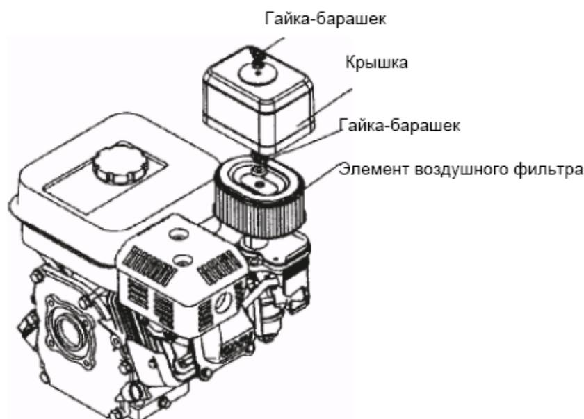
Бумажный элемент: Слегка похлопайте элементом несколько раз по твердой поверхности, чтобы стряхнуть излишек грязи, или продуйте фильтр сжатым воздухом изнутри наружу; чистка щеткой загонит грязь в волокна. Замените бумажный элемент, если он особенно грязен.
