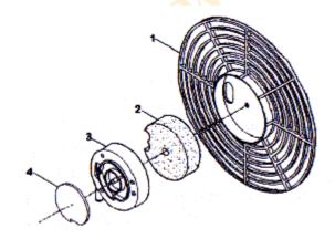
Воздушные фильтры следует регулярно проверять и чистить. В первую очередь фильтр забора воздуха (2), особенно если аппарат работает в пыльных помещениях. Для очистки нужно снять решетку (1), вынуть фильтр из гнезда (3), вымыть его со слабым моющим средством и высушить его перед тем, как установить вновь. Каждые 12 месяцев следует менять фильтр подачи воздуха (4).
