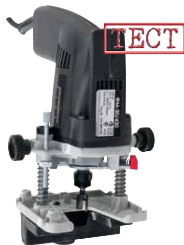
дался — купив кромочный фрезер, долго не мог им пользоваться из-за отсутствия в продаже фрез с 6-миллиметровым хвостовиком). Замечу, что прямая спиральная фреза 6 мм может быть переточена из 6-миллиметрового сверла по металлу, если есть хоть небольшой навык заточки инструмента и бормашинка с армированным отрезным диском. Полученной фрезе по стойкости, конечно же, далеко до твердосплавной, но лучше что-то, чем ничего.
